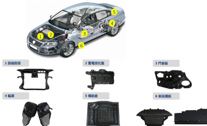
圖十七：玻纖複合材在乘用車的使用部位
