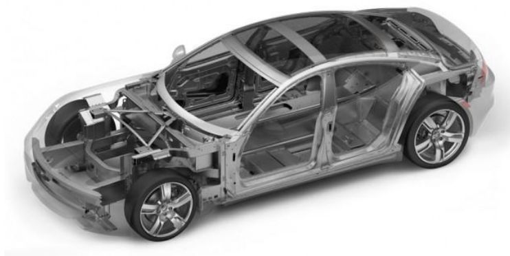
圖十一：Tesla 框架大量使用鋁合金
