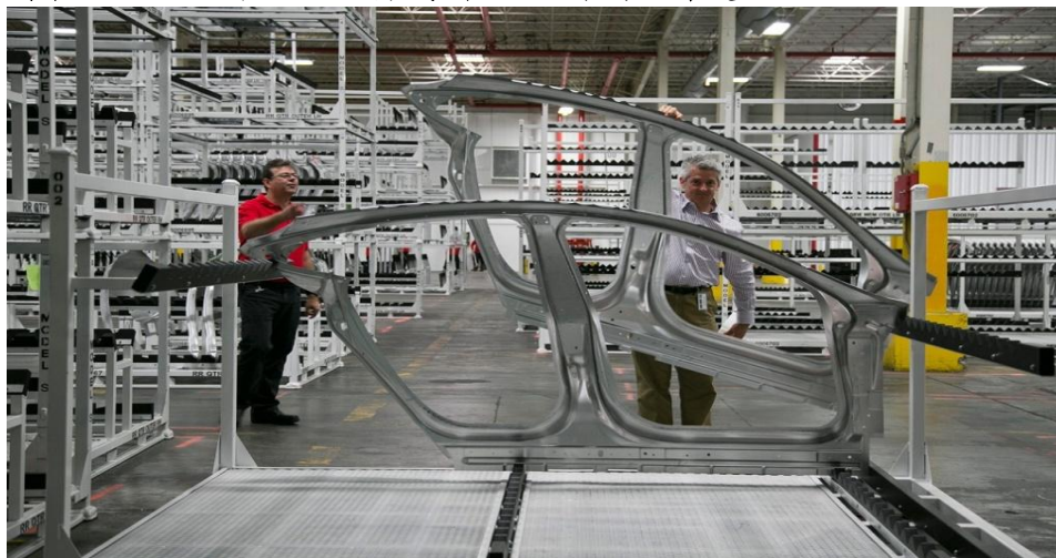
圖十二：Tesla 的鋁合金側板零件可用兩根手指舉起
